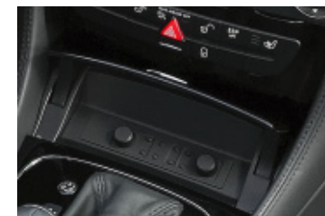
灰皿スペースへのメインコントローラー装着例
